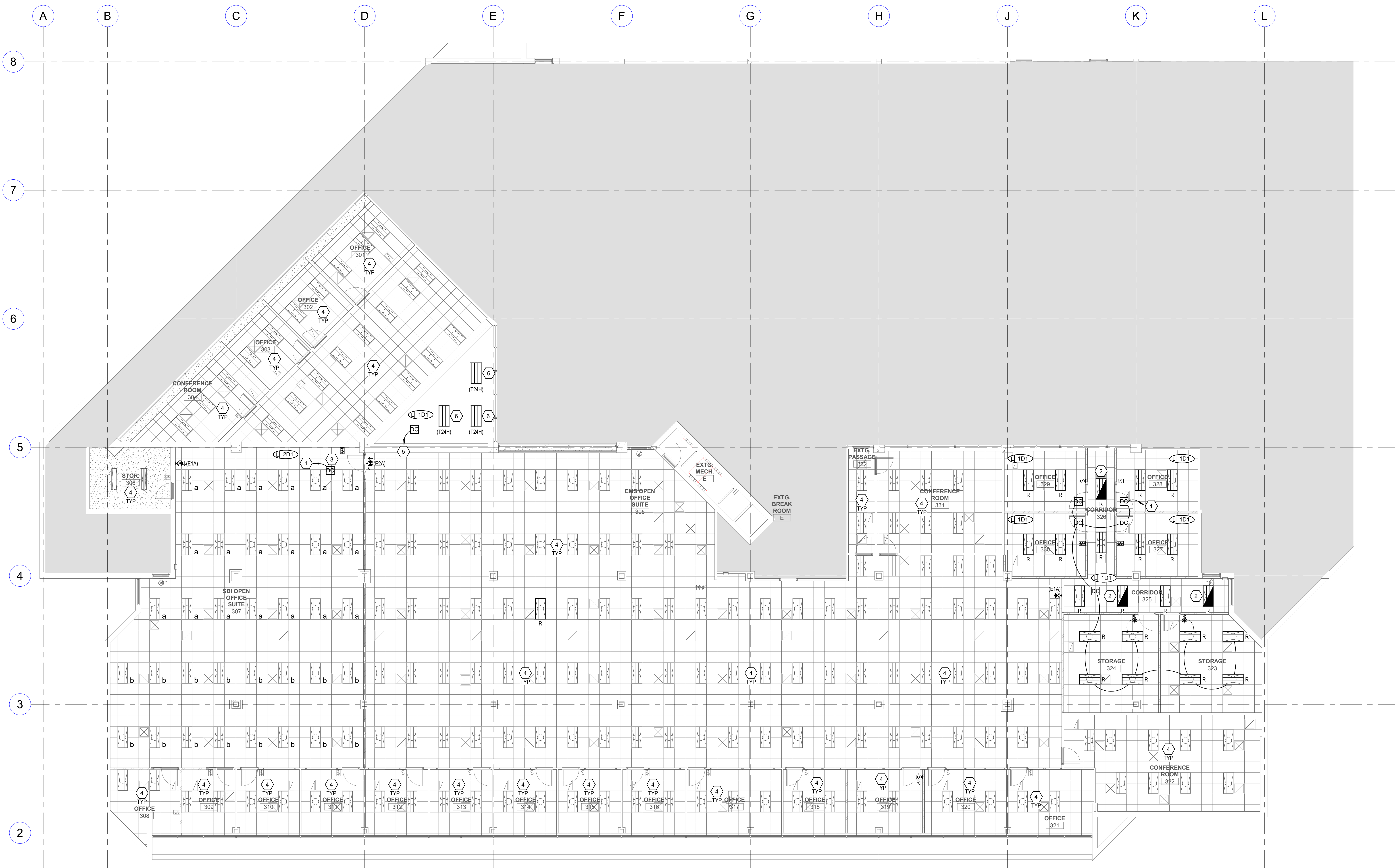
A1 LEVEL 3 LIGHTING PLAN SCALE: 1/8" = 1'-0"
